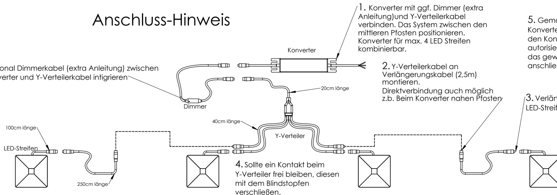
1. Konverter mit ggf. Dimmer (extra Anleitung) und Y-Verteilerkabel verbinden. Das System zwischen den mittleren Pfosten positionieren. Konverter für max. 4 LED Streifen kombinierbar.
