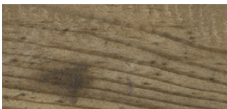
Stockflecken und leichter Schimmelbefall
