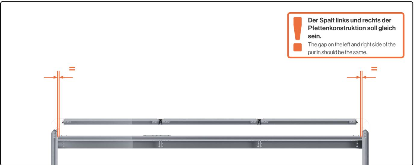
**Der Spalt links und rechts der Pfettenkonstruktion soll gleich sein.**
