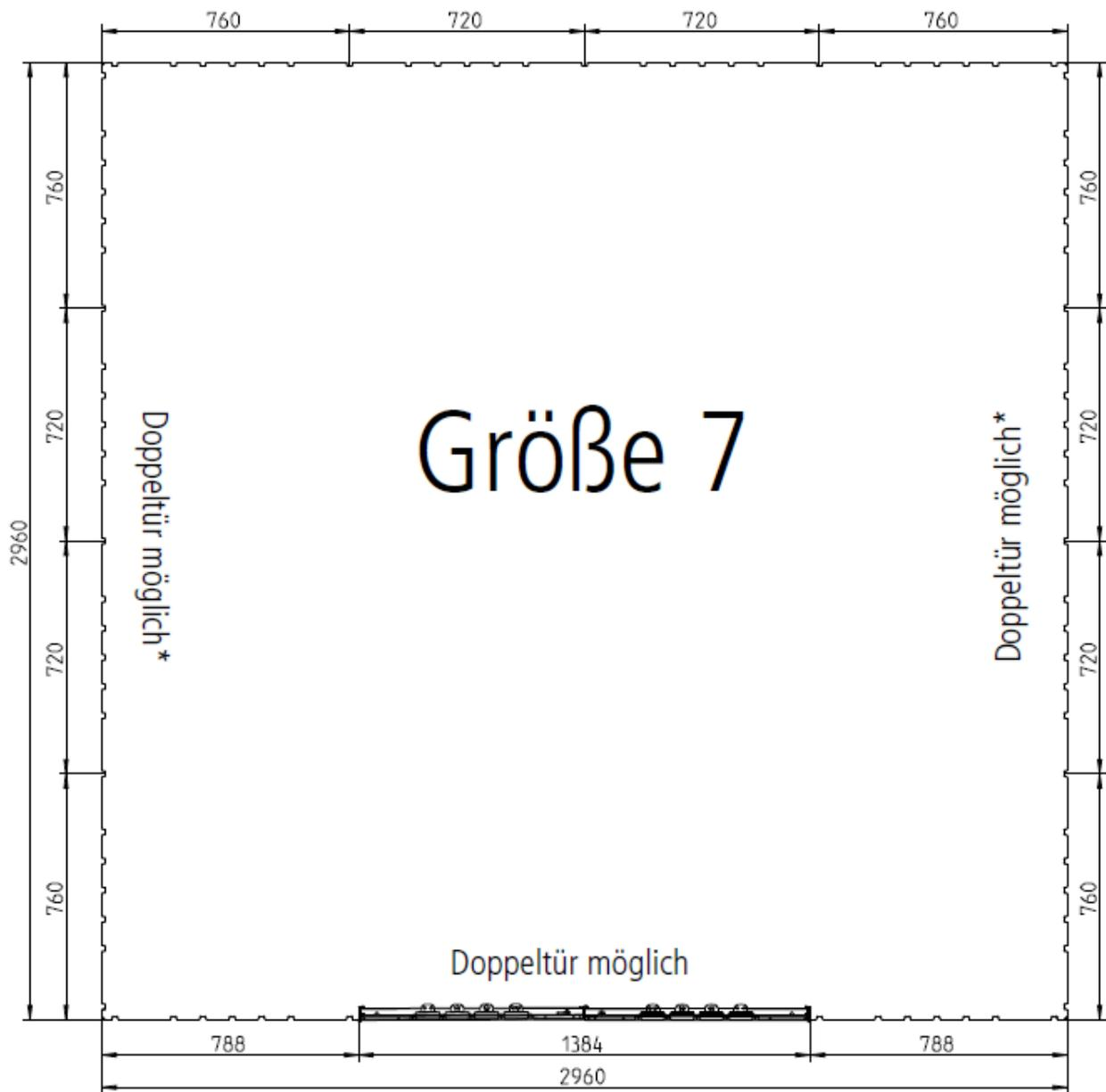
\*Bei seitlichem Einbau der Doppeltür gleich nach den ECKELEMEN-ten schränkt der Dachrinnen- auslauf den Öffnungswinkel der Tür ein.
