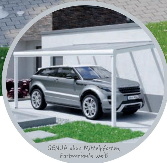
Die hochwertigen **Terrassenüberdachungen GENUA** und **MODENA** aus Aluminium, pulverbeschichtet in weiß (RAL 9016), verfügen über **11 x 11 cm starke Pfosten**, die vorne abgerundet sind. **Die Dacheindeckung besteht wahlweise aus 16 mm starken Doppelstegplatten oder aus 10 mm Verbundsicherheitsglas.**
