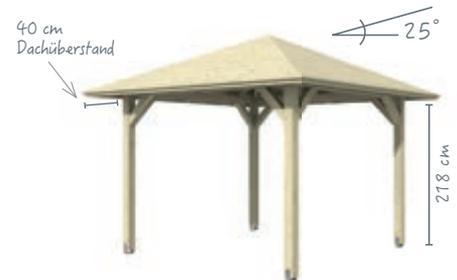
Hochwertiger 4-Eck-Pavillon CANNES aus Leimholz (BSH-Fichte), Pfosten 12 x 12 cm inkl. Aufschraubstützen. Umlaufender Dachüberstand 40 cm. Der Pavillon verfügt über eine massive Dachkonstruktion aus Vollholz. Das Montagematerial ist im Lieferumfang enthalten.
