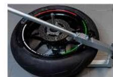
6. Reifen auf die unbearbeitete Seite drehen und von Felge lösen. Felge um 90 Grad drehen und Vorgang wiederholen, bis die gesamte Lauffläche von der Felge gelöst ist.
