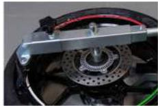
9. Montagearm mit Montagekopf auf Welle aufsetzen. Montagekopf muss bündig mit Felgenreand sein. Verlängerungshebel **bis Anschlag einführen!**
