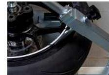
3. Abdrückschaufel so nah wie möglich zum Felgenrand ausrichten. Verlängerungshebel **bis zum Anschlag** einführen!
