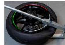
4. Reifen von der Felge lösen. Felge um 90 Grad drehen und Vorgang wiederholen, bis die gesamte Lauffläche von der Felge gelöst ist. **Rad muss beim Drehen richtig zentriert und positioniert sein!**
