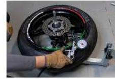
19. Reifen mit Luft befüllen. Nach zweimaligem Knallen ist der richtige Sitz des Reifens auf der Felge erreicht.
