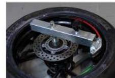
15. Zweite Reifenwulst soweit es geht von Hand eindrücken. Reifen quer über den Montagekopf laufen lassen.
