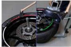
8. Nach dem Ablösen, Reifen und Montagekopf mit Montagepaste einschmieren. Anschließend Abdrückarm wegklappen.
