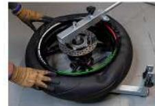
17. Beim letzten Stück muss mit erhöhtem Kraftaufwand die Reifenwulst über die Felge gebracht werden.
