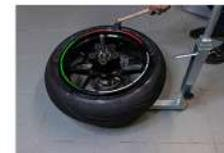
5. Nachdem der Reifen von der Felge gelöst ist, dann das Rad mit Montagepaste einschmieren.
