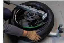
16. Verlängerungshebel in den Montagearm wieder bis zum Anschlag einführen. Montagekopf gegen den Uhrzeigersinn über das gesamte Rad drehen. Mit zweiter Hand den Reifen festhalten.
