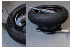
13. Prozess mit Montierhebel für zweite Reifenwulst wiederholen. Montiereisen zwischen Montagekopf und Wulst stülpen. Nach einer Umdrehung ist der Reifen von der Felge gelöst und kann entfernt werden.
