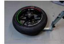
1. Nach Radausbau das Rad vorsichtig auf dem Reifenmontiergerät positionieren. Zentrierkonus auf Welle setzen um das Spiel zu reduzieren.
