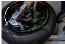
11. Gummierter Stopper einsetzen um das verdrehen der Felge zu vermeiden. **Wichtig: Stopper muss an Felge anliegen!**
