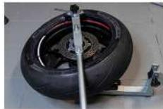
12. Montagearm mit Kraftaufwand gegen den Uhrzeigersinn um das gesamte Rad führen, bis die erste Reifenwulst von der Felge gelöst ist.
