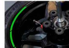
2. Ventil mit einem Ventilausdreher entfernen und Luft entweichen lassen.
