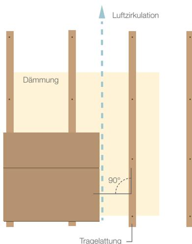
Verwenden Sie trockene Unterkonstruktionshölzer (Holzfeuchte max. 18 %; Empfehlung: Konstruktionsholz 40 x 60 mm, Festigkeitsklasse C24/Sortierklasse S10). Die Unterkonstruktion trägt nicht nur das Gewicht der Holzfassade. Sie muss auch auf Windlasten, insbesondere die erheblichen Kräfte des Windsoges ausgerichtet sein. Um eine sichere Befestigung der Vorhangfassade am Untergrund zu gewährleisten, wählen Sie einen Lattenabstand zwischen 50 und max. 70 cm.
