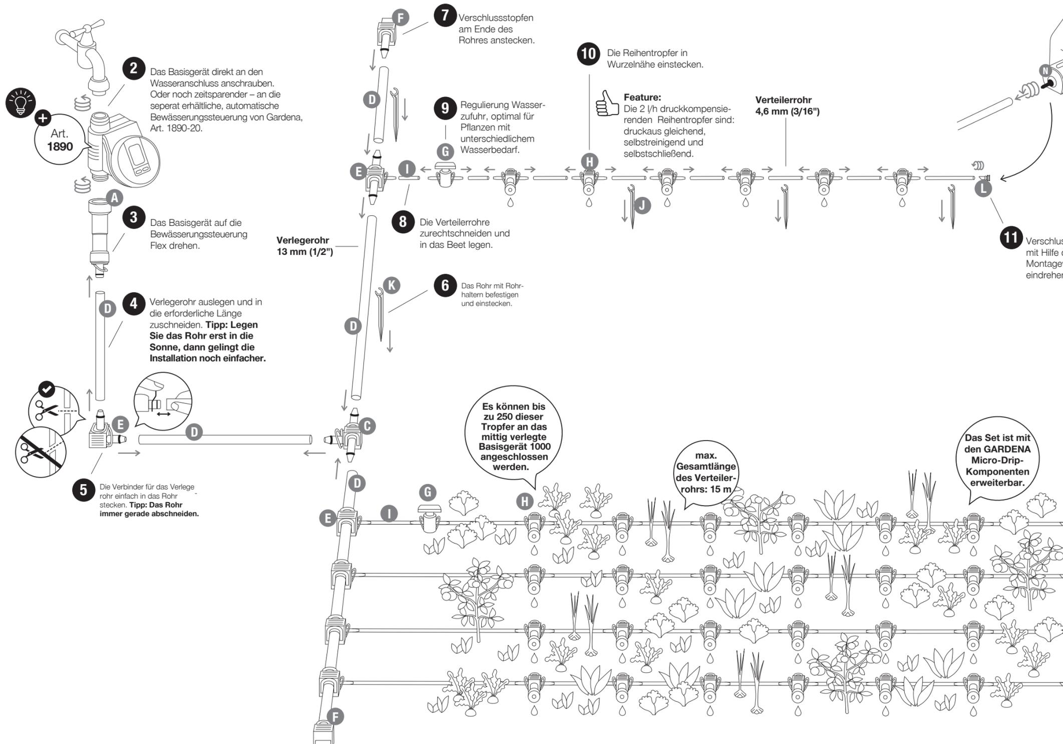
**2** Das Basisgerät direkt an den Wasseranschluss anschrauben. Oder noch zeitsparender – an die separat erhältliche, automatische Bewässerungssteuerung von Gardena, Art. 1890-20.
