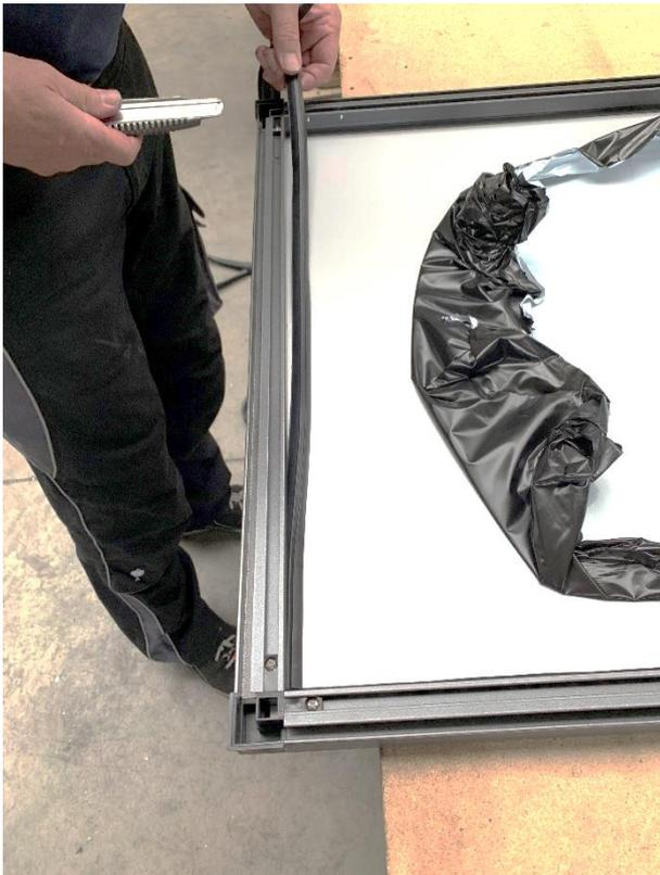
3. Die Dichtung auf die benötigte Länge kürzen
