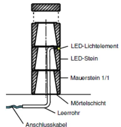
Für die Befestigung und Ausrichtung des LED-Leuchtelements muss die aus Kunststoff bestehende Ober- und Unterseite mit einem geeigneten Kleber an beiden Flächen, an den Betonteilen angeklebt werden.
