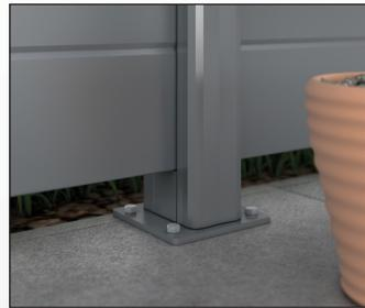
Montieren Sie die Bodenanker auf festem Untergrund (Fundament auf Eignung prüfen). Befestigen Sie die Pfosten auf dem Standfuß und führen Sie das Paneel in die Führungsschiene ein. Nur bis zu einer Höhe von 1500mm empfohlen.
