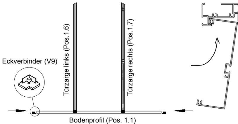
Zunächst schieben Sie bitte die Türzarge links (Pos. 1.6) und die Türzarge rechts (Pos. 1.7) in das Bodenprofil. Die Schräge muss hierbei nach außen zeigen. Anschließend je eine Sechskantschraube M6 x 12 in die Innennut am Ende des Bodenprofils einschieben. Dann die Eckverbinder (V9) auf das Bodenprofil aufstecken.
