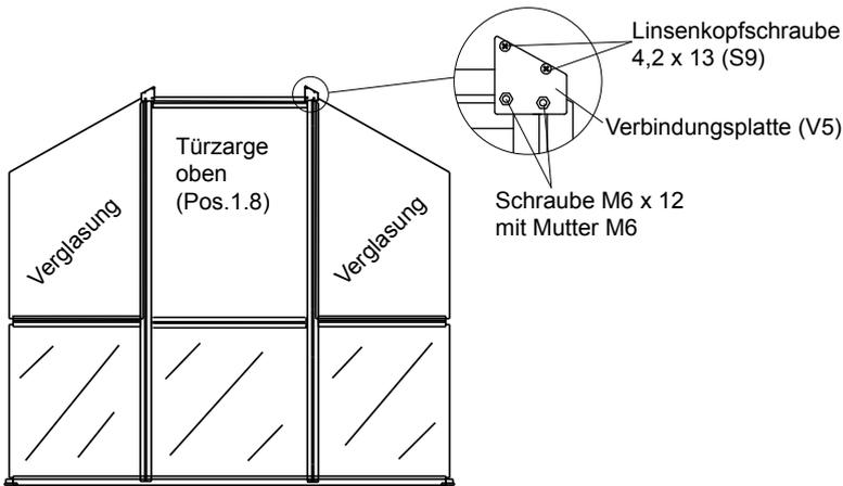
Bevor die Verbindungsplatte (V5) mit der Türzarge oben (Pos. 1.8) verschraubt wird, schieben Sie jeweils eine weitere Schraube in die senkrechten Türzargen (Pos. 1.6/1.7) und zwei Schrauben M6 x 12 (S12) ein in die Türzarge oben (Pos. 1.8)
