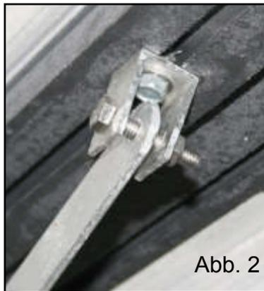
Der U-Verbinder wird jeweils links und rechts, mit ca. 410 mm Abstand (siehe Abb. 1) vom Firstprofil im Schraubkanal der Dachspresse befestigt.
