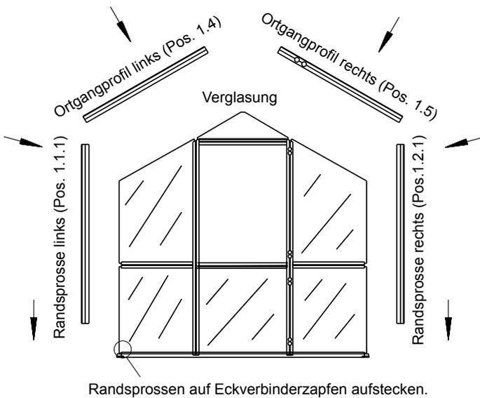
Auf den Vierkantzapfen des Eckverbinders werden die Randsprossen (Pos. 1.2/1.3) gesteckt. Kleine dreieckige Verglasung auf der Türzarge (Pos. 1.8) positionieren.
