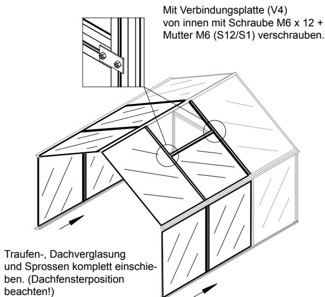
Zur Befestigung der Quersprossen verwenden Sie die Verbindungsplatte (V4). Diese wird mit den Sechskantschrauben M6 x 12 verschraubt.
