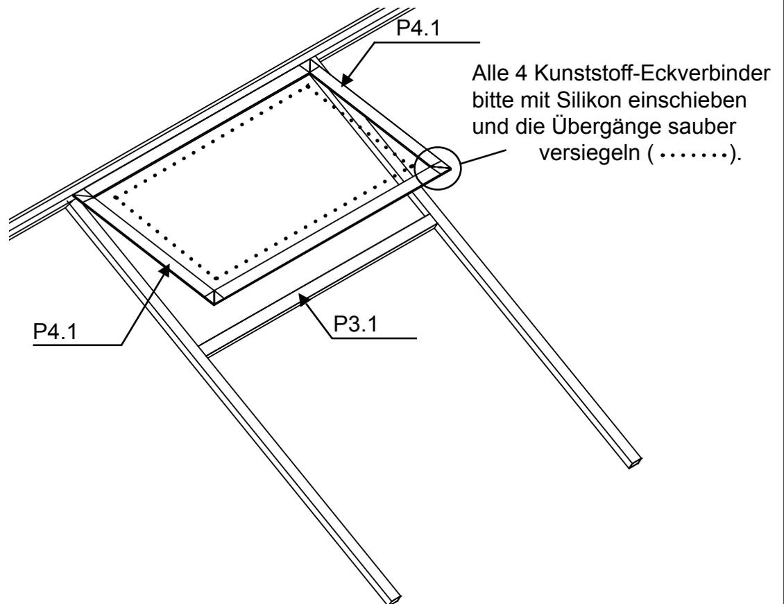
Die Übergänge der Verglasung, sowie die der Kunststoff-Eckverbinder, zum Dachfensterprofil bitte mit Silikon versiegeln ..... → siehe Skizze.
