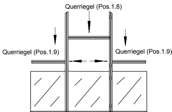
Nun werden die beiden Querriegel (Pos. 1.9) von oben auf die Verglasung gesteckt und seitlich von Innen mit den Linsenkopfschrauben 4,2 x 50 verschraubt.
