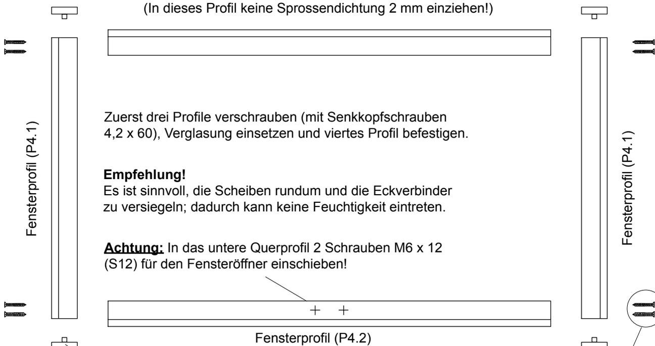
Zuerst drei Profile verschrauben (mit Senkkopfschrauben 4,2 x 60), Verglasung einsetzen und viertes Profil befestigen.
