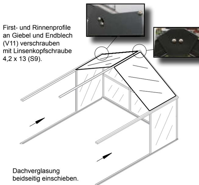
First- und Rinnenprofile an Giebel und Endblech (V11) verschrauben mit Linsenkopfschraube 4,2 x 13 (S9).
