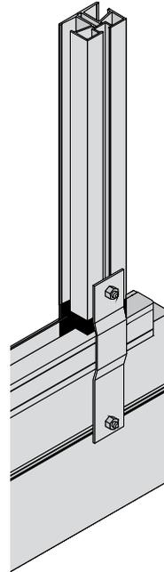
Zur Stabilisierung des Hauses werden die Befestigungslaschen (V27) mittels eingezogener Schrauben M6 x 12 (S12) am Fundamentrahmen und an den Seitensprossen bzw. Türzargen angeschraubt.
