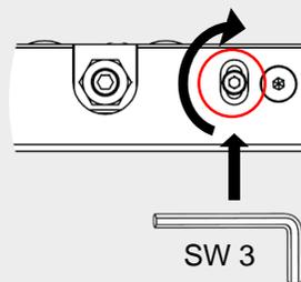
Abstand der Aushebesicherung zum Aluprofil auf 1-2mm einstellen und festziehen.
