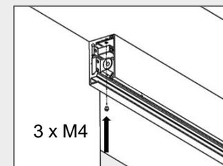
Deckenbefestigung / ceiling mounting
