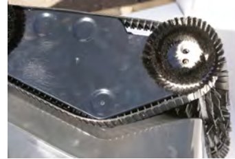
4.2 Setzen Sie die Seitenbürsten ein
