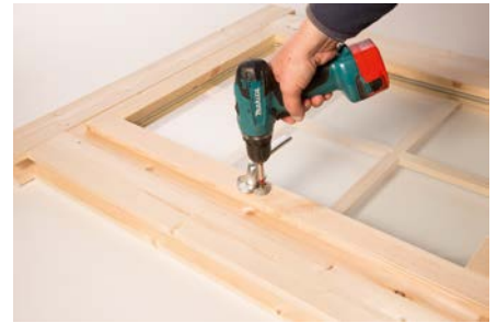
6. Anschrauben / Montage Fenstergriff
