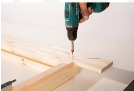
7. Anschrauben der Blende oben
