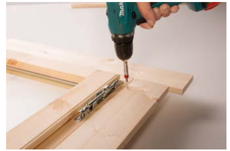
3. Anschrauben der Blenden
