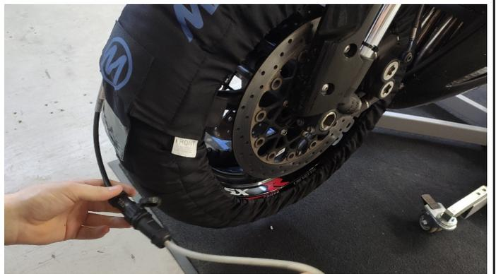
7. Mit dem digitalen Regler kann die Temperatur jetzt eingestellt werden. Die roten LEDs werden aufleuchten, sobald der Reifenwärmer aufheizt. Sie erlöschen, wenn der Reifenwärmer die eingestellte Temperatur erreicht hat. Diese Temperatur wird nun gehalten. Als grober Richtwert für die richtige Reifentemperatur sollte die Felge berührungswarm sein.
