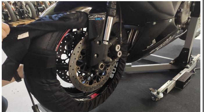
6. Nachdem beide Reifenwärmer angebracht wurden, können diese nun mit dem digitalen Regler verbunden werden. Das graue Kabel ist für den vorderen Reifenwärmer und das schwarze Kabel ist für den hinteren Reifenwärmer.
