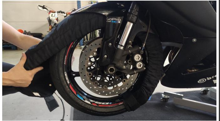
5. Nach einer vollständigen Umdrehung des Rades können nun beide Enden des Reifenwärmers mit dem Klettstreifen verbunden werden.
