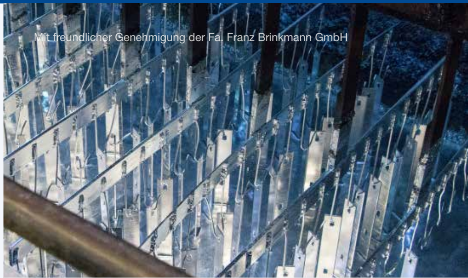
Feuerverzinken: Metallüberziehung im Tauchverfahren
