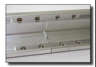
Die Profile (Pos. 1 bzw. Pos. 1.1) sind, wie dargestellt, so zu verbinden, dass folgende Profillängen entstehen:
