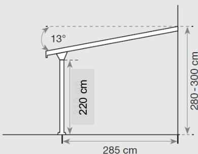
Die Durchgangshöhe an der Traufe variiert je nach Dachneigung. Bei Ausladung von 285 cm beträgt diese **220 cm**.
