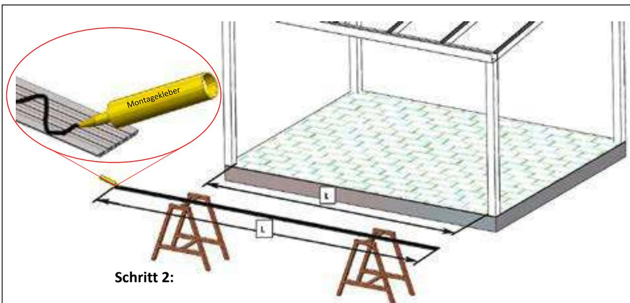
Tragen Sie den Montagekleber auf die Unterseite der Laufschiene AL22 auf und drücken Sie diese zwischen den Pfosten auf dem Boden fest.
