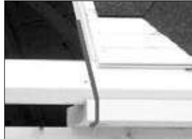
Vorgang Trennschnitt durch die Dachtraverse. Linie gleich Schnittpunkt und Schnittrichtung!
