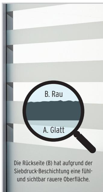
Die Rückseite (B) hat aufgrund der Siebdruck-Beschichtung eine fühl- und sichtbar rauere Oberfläche.
