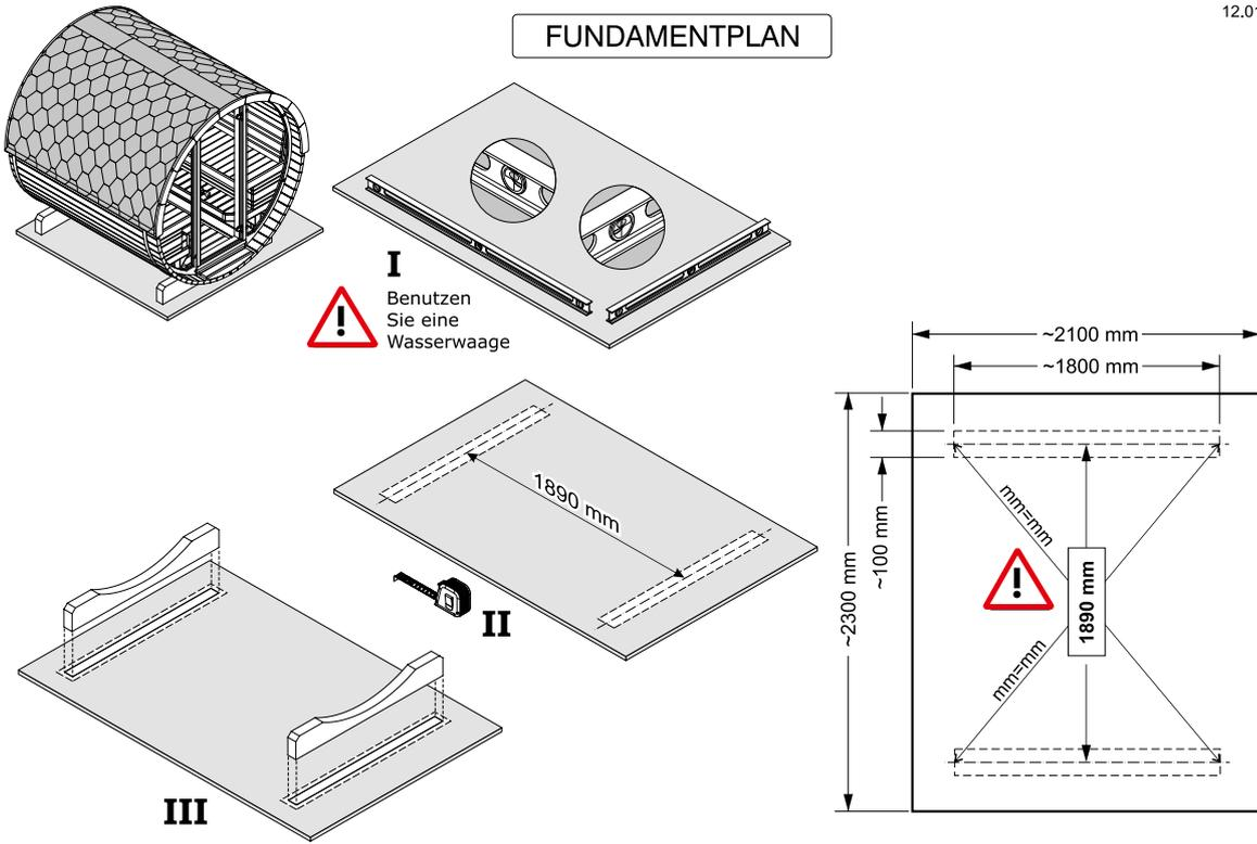
Wir empfehlen ein vollflächiges Fundament: 2100x2300 mm
