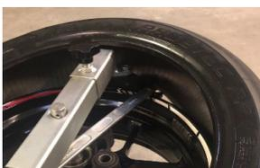
18. Bevor der neue Reifen verbaut wird, beide Reifenwülste mit Montierpaste einschmieren. Reifen über Felge stülpen. Erste Reifenwulst kann per Hand übergestülpt werden
