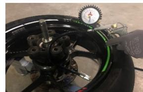
23. Ventileinsatz wieder reinschrauben. Reifen mit Luft befüllen. Nach zweimaligen Knallen ist der richtige Sitz des Reifen auf der Felge erreicht
