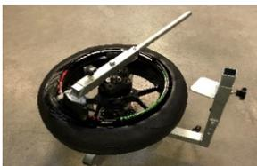
15. Montagearm mit Kraftaufwand gegen den Uhrzeigersinn um das gesamte Rad führen. Reifenwulst wird über die Felge gestülpt
