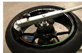
22. Beim letzten Stück muss mit erhöhten Kraftaufwand der Reifenwulst über die Felge gebracht werden
