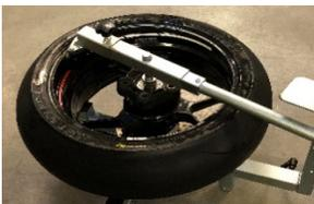
17. Prozess mit Montiereisen für zweite Reifenwulst wiederholen. Montiereisen zwischen Montagekopf und Reifenwulst einführen und über Montagekopf stülpen. Nach einer Umdrehung ist der Reifen von der Felge gelöst und kann entfernt werden. Demontage ist abgeschlossen
