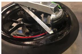
13. Mit Hilfe des Montiereisens den Reifenwulst über den Montagekopf stülpen
