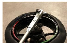
21. Verlängerungshebel in den Montagearm einsetzen. Montagekopf entgegen dem Uhrzeigersinn über das gesamte Rad drehen. Mit zweiter Hand den Reifen festhalten, damit dieser nicht vom Montagekopf gleitet
